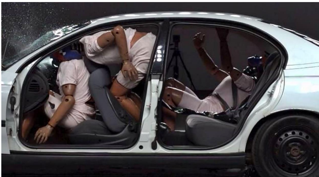
Rasm-51. Salon ichidagi xaydovchi va yo‘lovchilarning to‘qnashuv vaqtida jarohatlar olish jarayoni manikenda ko‘rsatilgan.
