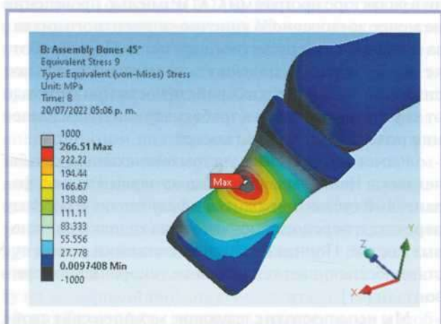
Рис. 4. Конечно-элементная модель первого плюснефалангового сустава без эндопротеза. Модель приведена при усилнии нагрузки 110 кг. Угол тыльного сгибания соответствует 45°.
