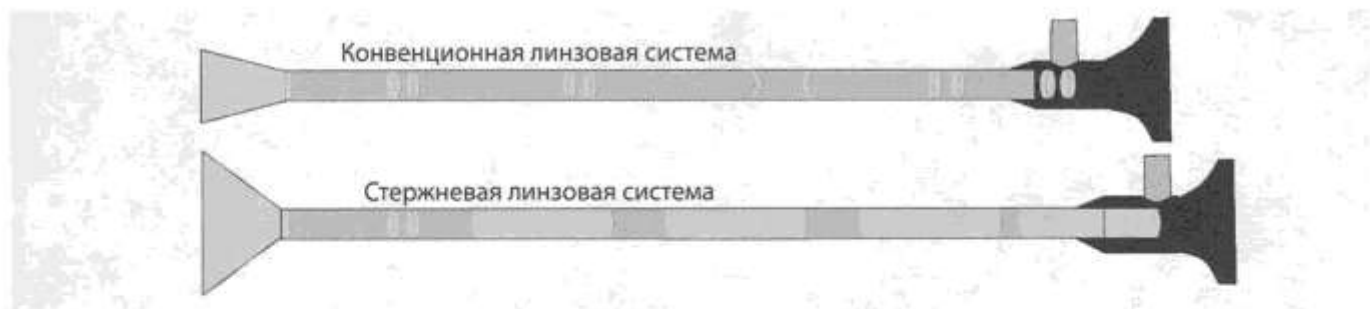
Рисунок 1. Эндоскопы с обычной и стержневой линзовой системой.
