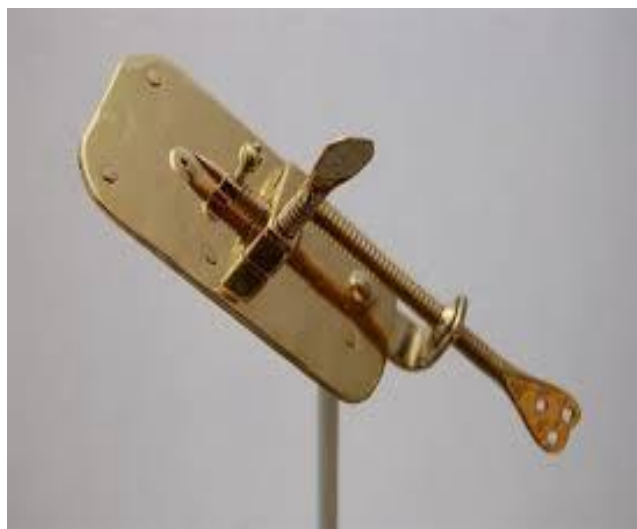
Рис. 12. Микроскоп А. Левенгука. В верхней части металлической пластинки закреплено увеличительное стекло (а). Наблюдаемый объект располагался на кончике острой иглы (б). Винты служили для фокусировки
