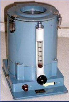
Аппарат Кротова для взятия проб воздуха
