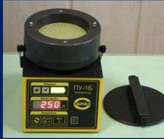
Устройство автоматического отбора проб воздуха ПУ-1Б
