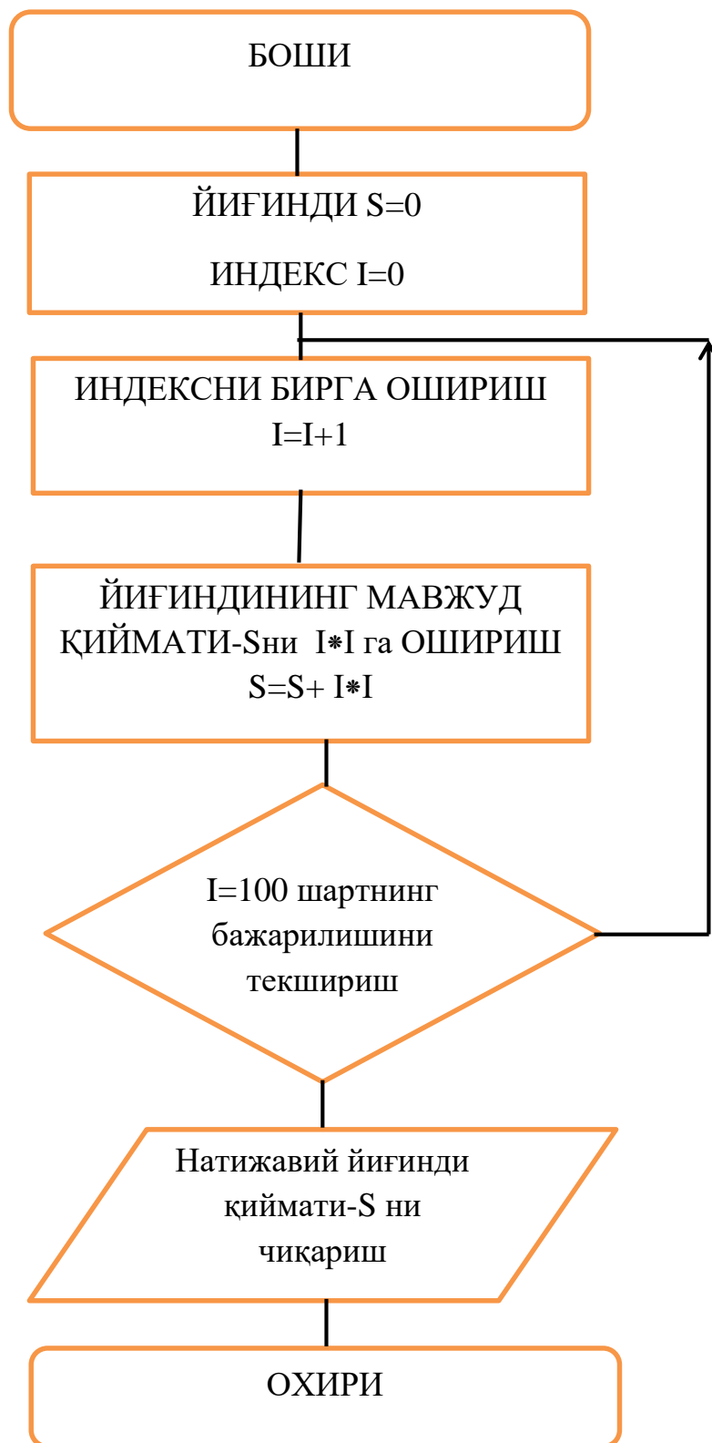
Расм 2. Natural сонлар квадратлари йиғиндисини ҳисоблаш алгоритмининг блок схемаси.
