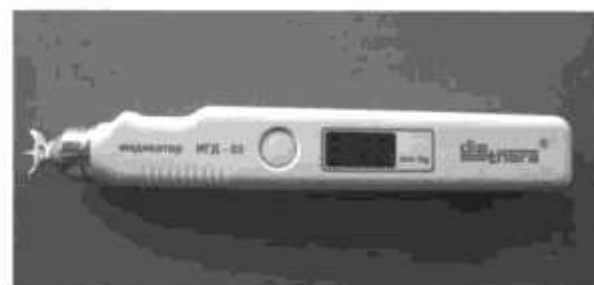
Рис. 2. Магнитодинамический индикатор давления ИГД-03
