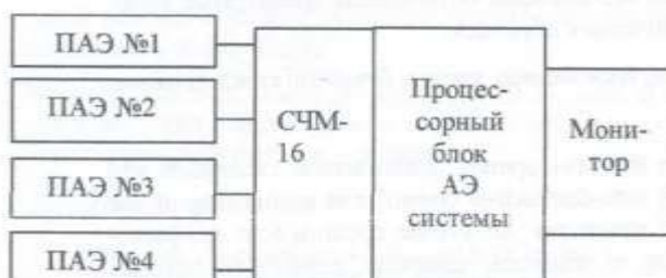
Рисунок 1. Функциональная схема АЭ системы: ПАЭ (пьезодатчики) №1, №2, №3, №4, процессорный блок с модулем счетчика СЧМ-16, монитор.
