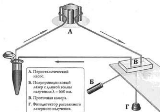
Рисунок 1. Микрофлюидное устройство для регистрации кинетики адгезии тромбоцитов в условиях контролируемого потока
