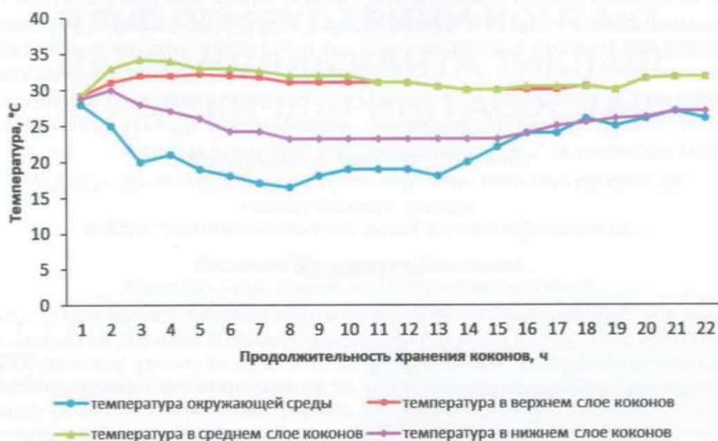
Рис. 3. Изменение температуры живых коконов в различных слоях при хранении их в тара-ящиках
