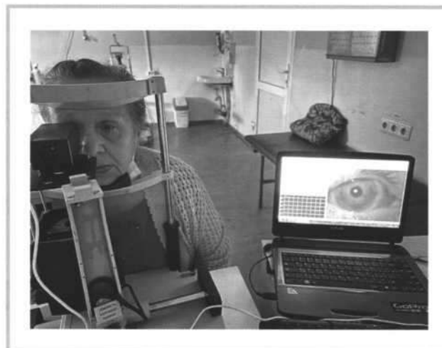
Рис. 2. Малогабаритный спектрофлуориметр для исследований в офтальмологии.
