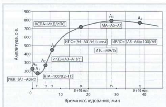
Рис. 1. Кривая пьезотромбоэластограммы с указанием параметров. ИКК — интенсивность контактной фазы коагуляции; ИКД — интенсивность коагуляционного драйва; КТА — константа тромбиновой активности; ИПС — интенсивность полимеризации сгустка; ИТС — интенсивность тотального свертывания крови; ИРЛС — интенсивность ретракции и лизиса сгустка; КСПА — коэффициент суммарной противосвертывающей активности; о.е. — относительные единицы; МА — максимальная амплитуда сгустка.
