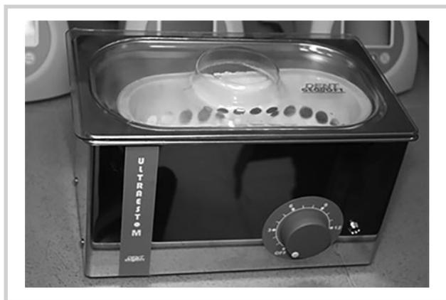
Рис. 3. Применение устройства «UltraEst-M» для ультразвуковой обработки образцов стоматологических материалов при проведении модельных экспериментов первичной адгезии тест-штаммов микроорганизмов.
