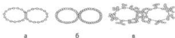
Рисунок 1. Структуры стабилизирующего слоя наночастиц, образующиеся между дисперсионными фазами в эмульсии: (а) монослой, (б) бислой и (в) разветвлённая сетка агрегатов [2].
