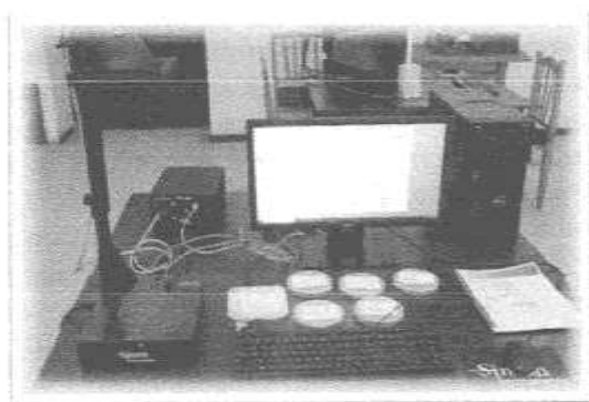
Рисунок 1. Общий вид системы Sinton WCT-120 (Sinton Instruments, USA, 2019) для измерения времени жизни неосновных НЗ в полупроводниках.
