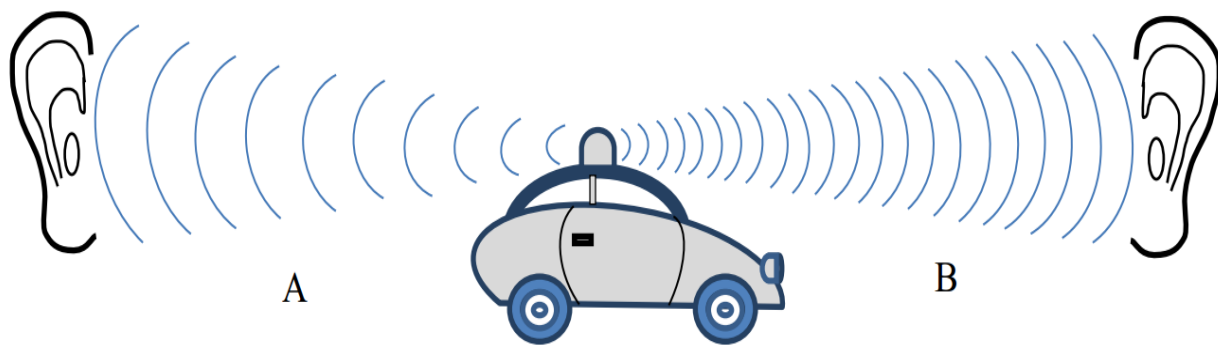
21-rasm. Doppler effekti sxemasi - tovush manbai (A) dan tovushni qabul qiluvchi (B) tomon yoʻnalishda harakat qilganda tovush toʻlqini chastotasining oʻzgarishi.
