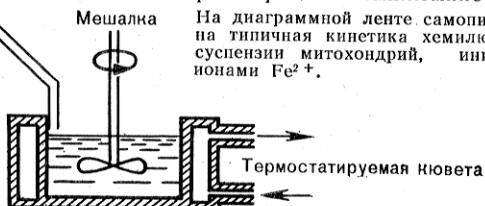
Рис. 12. Блок-схема установки для регистрации хемилюминесценции.
